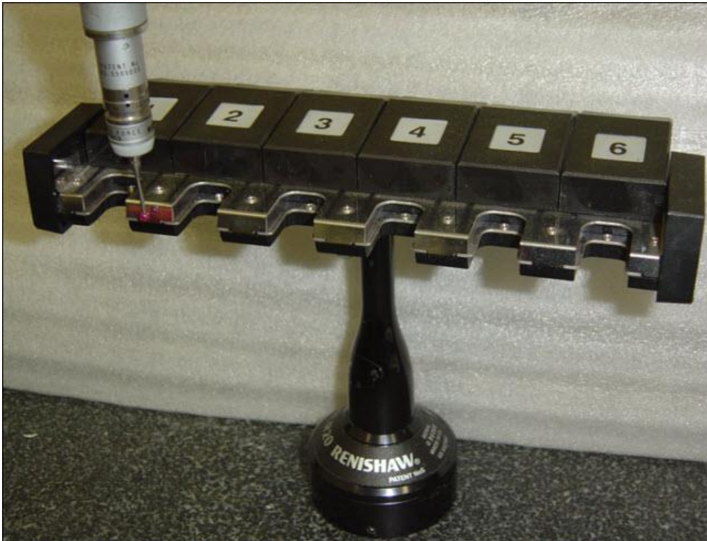
Exemplo mostrando a localização do primeiro toque manual durante a calibração do TP20.
