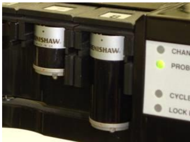
Trocador de sonda ACR1, mostrando duas extensões de sonda diferentes usadas aqui nos slots 7 e 8
