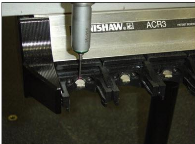
Exemplo mostrando o primeiro toque da sonda dentro da parte traseira da porta 1.
