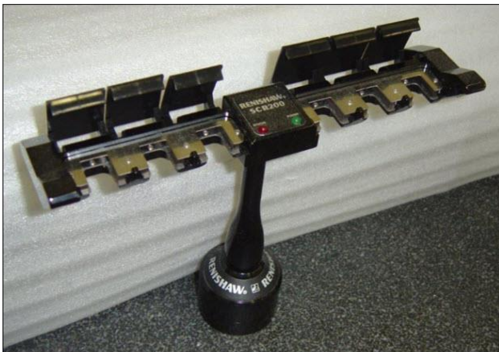
Exemplo mostrando as tampas da porta abertas antes da calibração.
