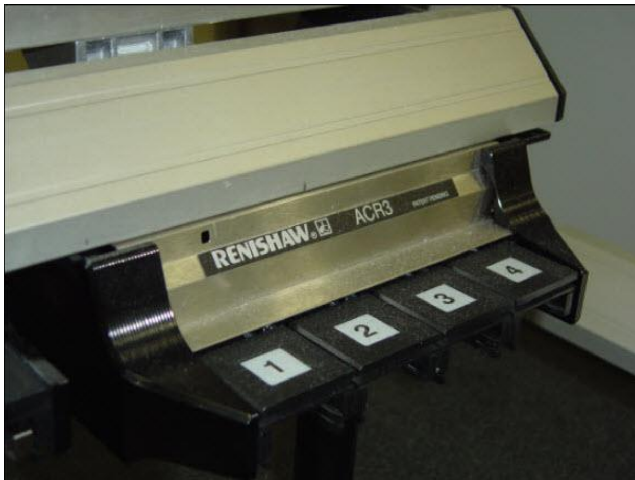
Rack do trocador de sonda ACR3 da Reninshaw
