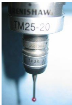
Módulo TM25-20 e o estilo tipo TP20
