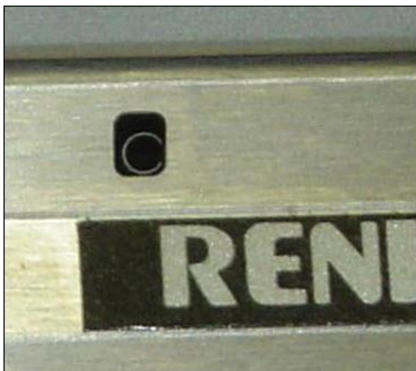
Exemplo mostrando o alinhamento visual do trocador de sonda.
