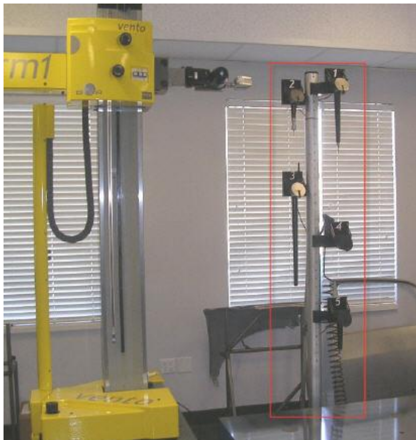
Trocador de Sonda CW43 vertical com cinco portas
