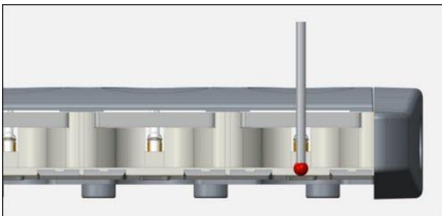
Vista do quarto toque na superfície superior da guia de suporte da sonda
