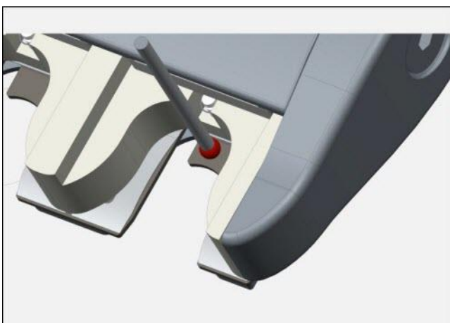
Vista do quarto toque na superfície superior da guia de suporte da sonda, na parte de trás da porta
