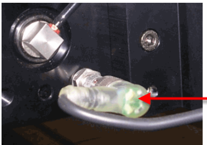
Conexão solenóide com LED de luzes verde e âmbar
