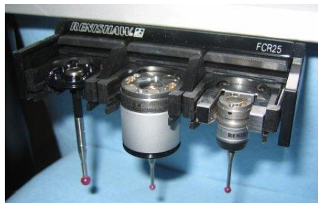
Inserções do trocador de sonda FCR25 e tipos de sonda
