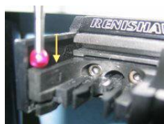
Primeiro toque na superfície superior da porta 1
