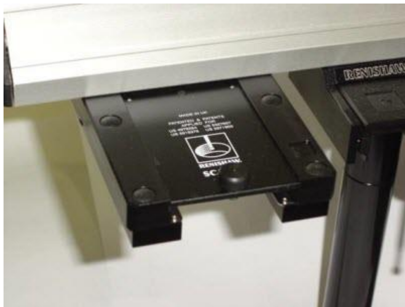
Um rack de troca de caneta Renishaw SCP600
