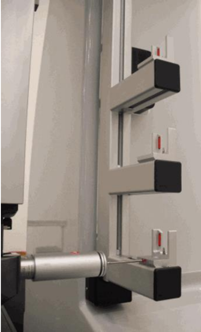
Toque horizontal na superfície frontal vertical e plana da porta inferior - exibição 1
