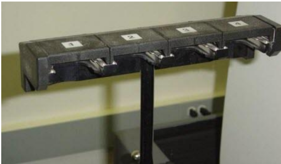
Um rack de troca de estilo Renishaw SP600 (SCR600)
